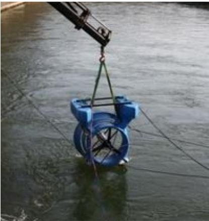
Micro turbina hidroeléctrica. Tiene una potencia de 5 kW, está pensado para aprovechar la fuerza cinética de los ríos y generar electricidad en zonas aisladas.
